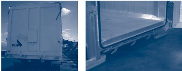
Figure 6.4.1.a. – Single-part leakproof door
